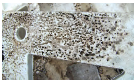
Badewannenträger aus Styropor mit Ameisengängen
